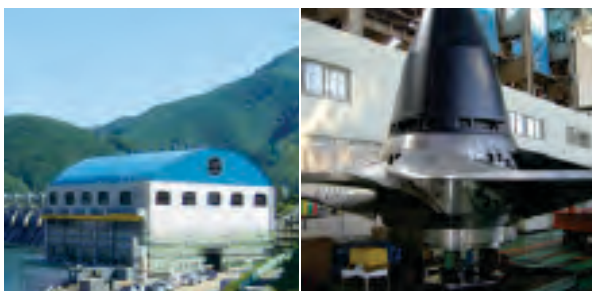
Cheongpyeong Hydraulic Power Plant Kaplan turbine runner (South Korea) Nhà máy thủy điện Cheongpyeong (Hàn Quốc)
