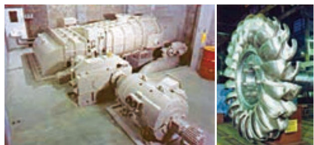
Cross-flow water turbine & Pelton wheel Tua-bin dạng dòng chảy & bánh xe kiểu Pelton
